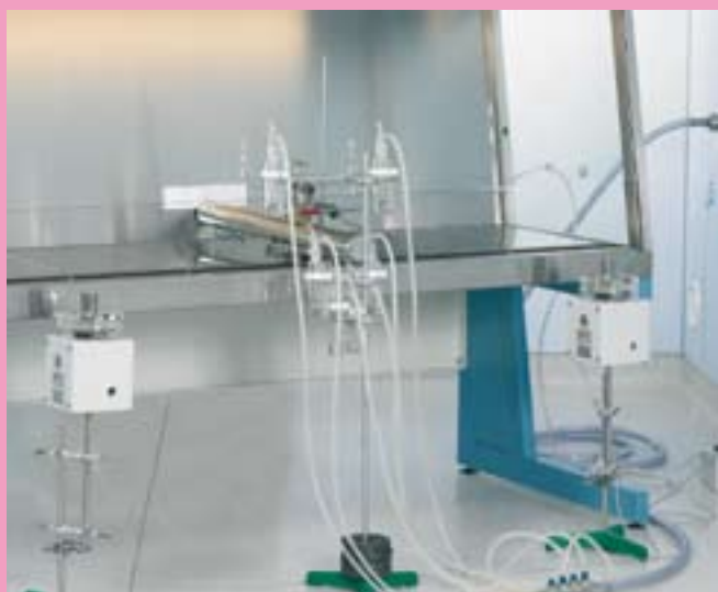
Abb. 2 Teststand mikrobiologische Prüfung des Personenschutzes.
