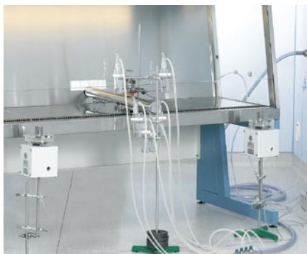
Abb. 5: Teststand mikrobiologische Prüfung des Personenschutzes.
