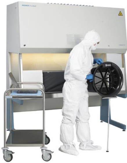
Abb. 4: Messung der Luftertrittsströmungsgeschwindigkeit.
