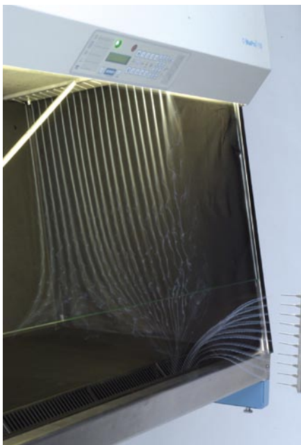
Abb. 1: Verdrängungs- und Lufteintrittsströmung im Rauchversuch.
