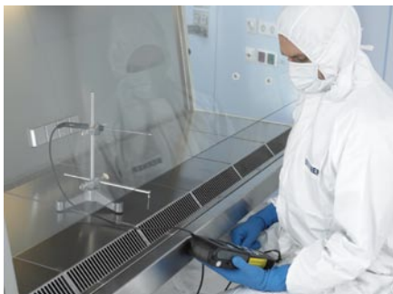
Abb. 3: Messung der turbulenzarmen Verdrängungsströmungsgeschwindigkeit.
