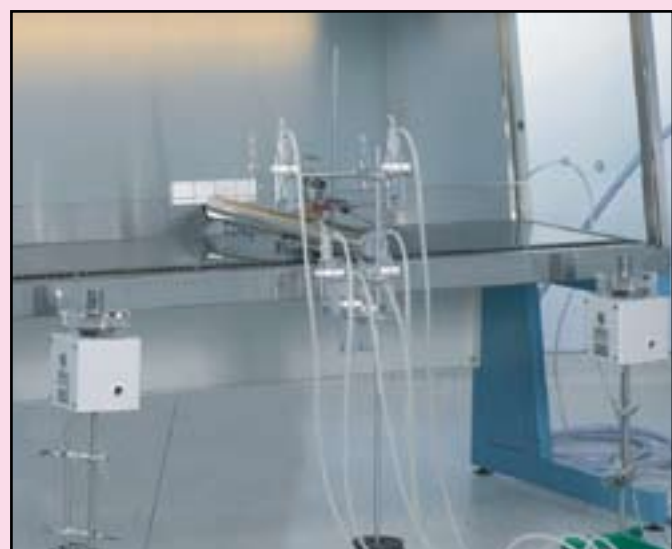
Abb. 3 Teststand, mikrobiologische Prüfung des Personenschutzes.
