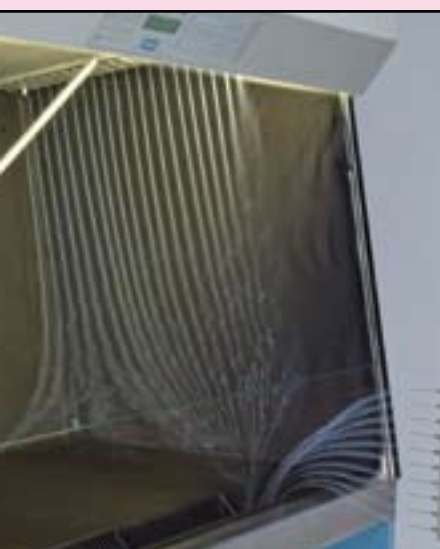
Abb. 2 Verdrängungs- und Lufteintrittsströmung im Rauchversuch.
