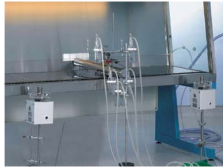
Abb. 3: Teststand, mikrobiologische Prüfung des Personenschutzes.
