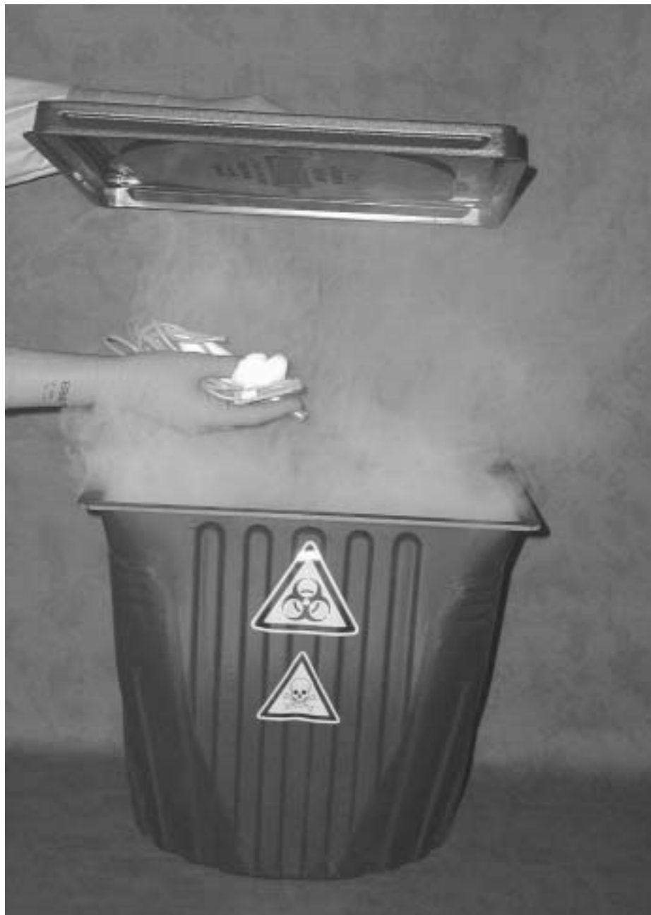
Abb. 2: Visualisierung von Luftbewegungen beim Öffnen und Schließen von Abfallbehältern
