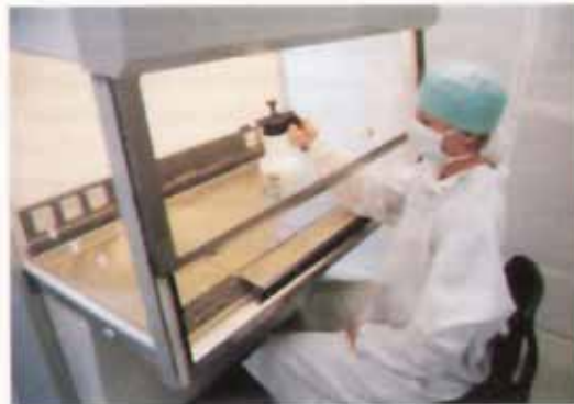
Abb. 4: Prüfung der Reinigbarkeit des Arbeitsraumes, der Arbeitsplatte und der Auffangwanne gem. EN 12469
