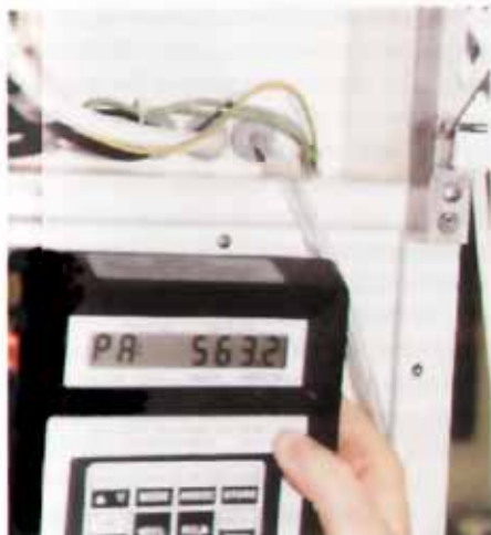
Abb. 4: Prüfung der Reinigbarkeit des Arbeitsraumes, der Arbeitsplatte und der Auffangwanne gem. EN 12469
