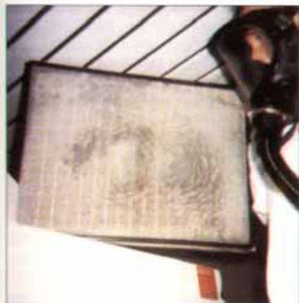
Bild 4: Staubkuchen auf einem Abluftfilter einer Swb der Klasse 2 → Kein Personen- und Produktschutz!
