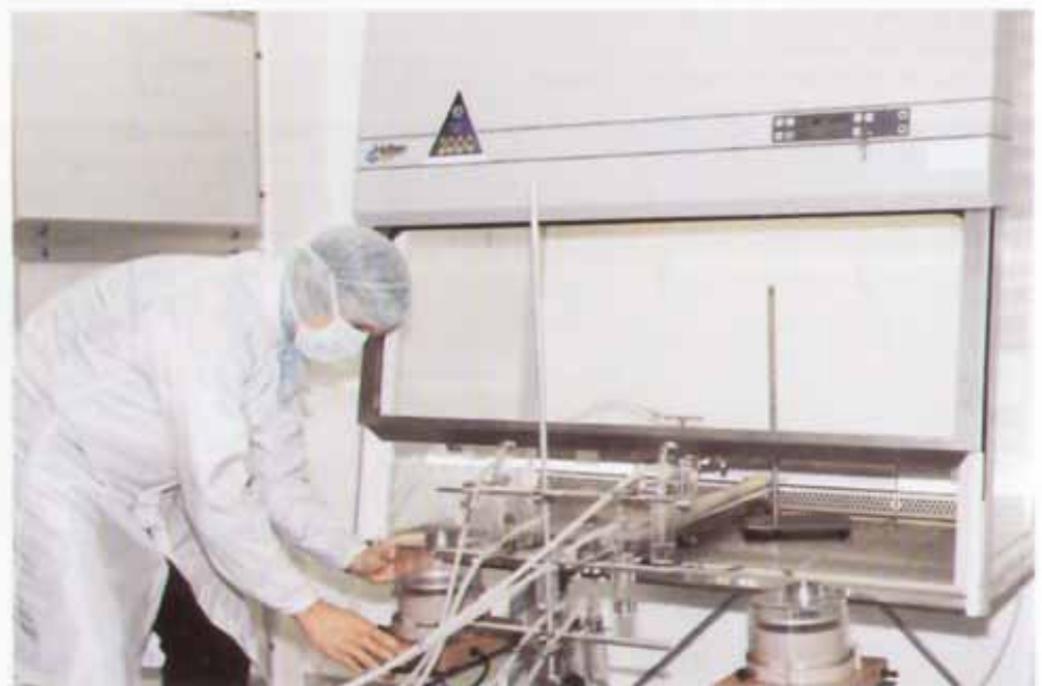
Abb. 1: Aufbau der Prüfeinrichtung für die mikrobiologischen Prüfung des Rückhaltevermögens (Personenschutz)
