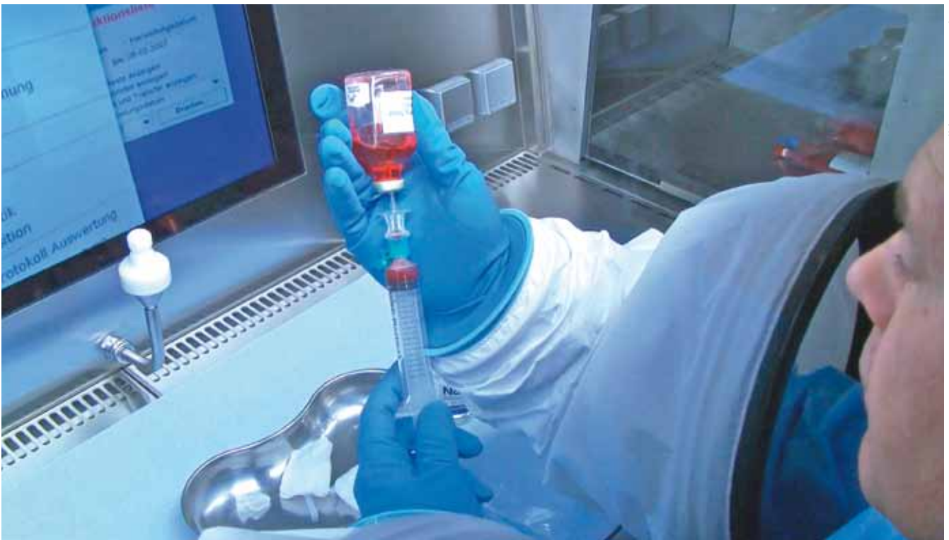
1 Handschuh- und Ärmelsystem in einem Zytostatika-Isolator.
