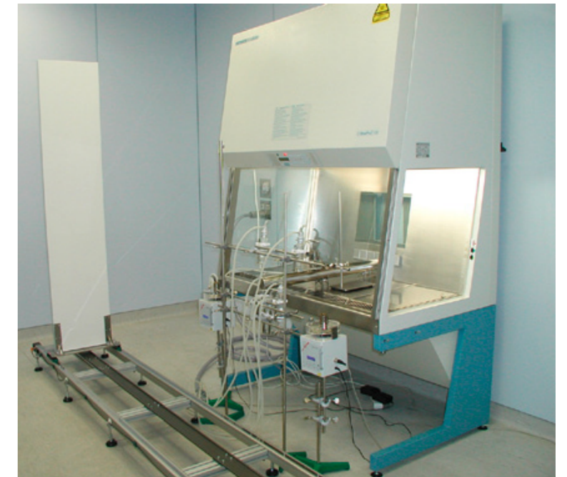
Abb. 3 Beispiel für eine künstliche Störgröße zur Simulation dynamischer Einflüsse auf das Schutzpotenzial einer Sicherheitswerkbank. Mit einer bewegten Platte lassen sich Personalaktivitäten reproduzierbar nachstellen und bewerten.
