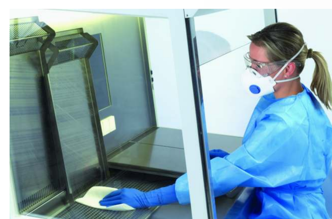
Reinigung des Arbeitsraumes
