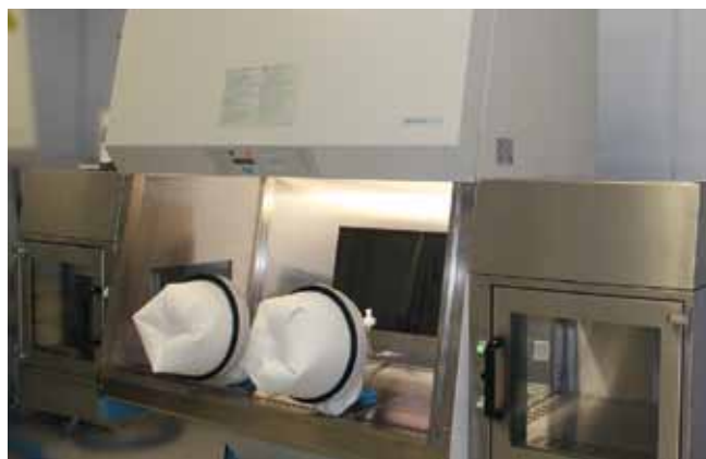
Abb. 2. Zytostatika-Isolator [Foto: Berner International GmbH]
