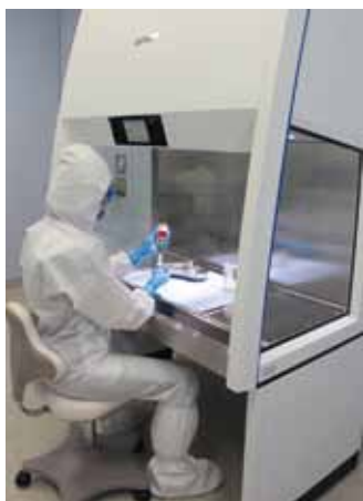
Abb. 1. Sicherheitswerkbank für die Zytostatikaherstellung [Foto: Berner International GmbH]
